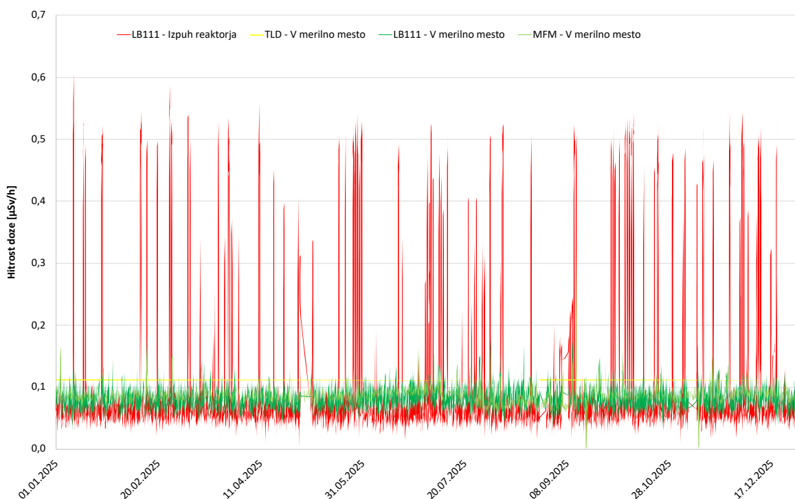
Slika 6: Meritve za leto 2025: hitrost doze na izpuhu reaktorja – kontinuirni merilnik Berthold LB111 (rdeča, Oznaka: 1.6HD), na vzhodni kontrolni točki – kontinuirna merilnika Berthold LB111 (temno zelena) in merilnik MFM (svetlo zelena, Oznaka: 2.5HD) ter letno povprečje vzhodne kontrolne točke – TLD (rumena, Oznaka: 2.6HD)
