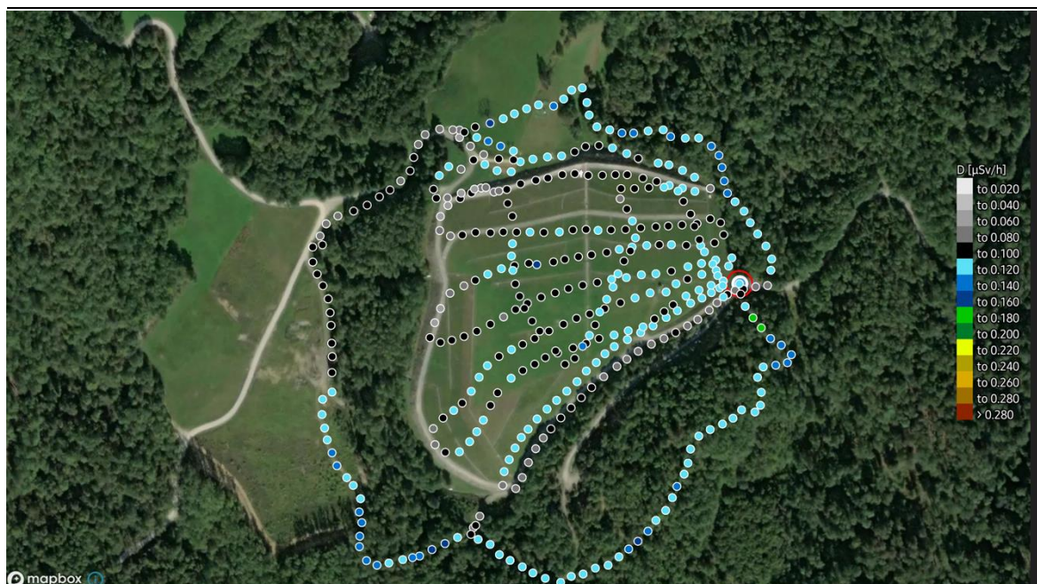
Slika 18: Meritve hitrosti doze zunanjega sevanja gama na površini odlagališča Boršt. Meritve je izvedel ZVD 12.12.2024.
